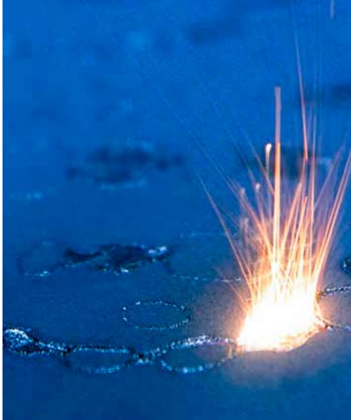
Procedeu de sinterizare cu laser (DMLS), utilizat pentru punți și coroane dentare.
